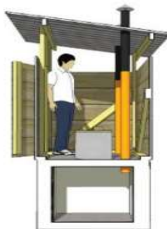
Letrina lavable conectada a tanque séptico
